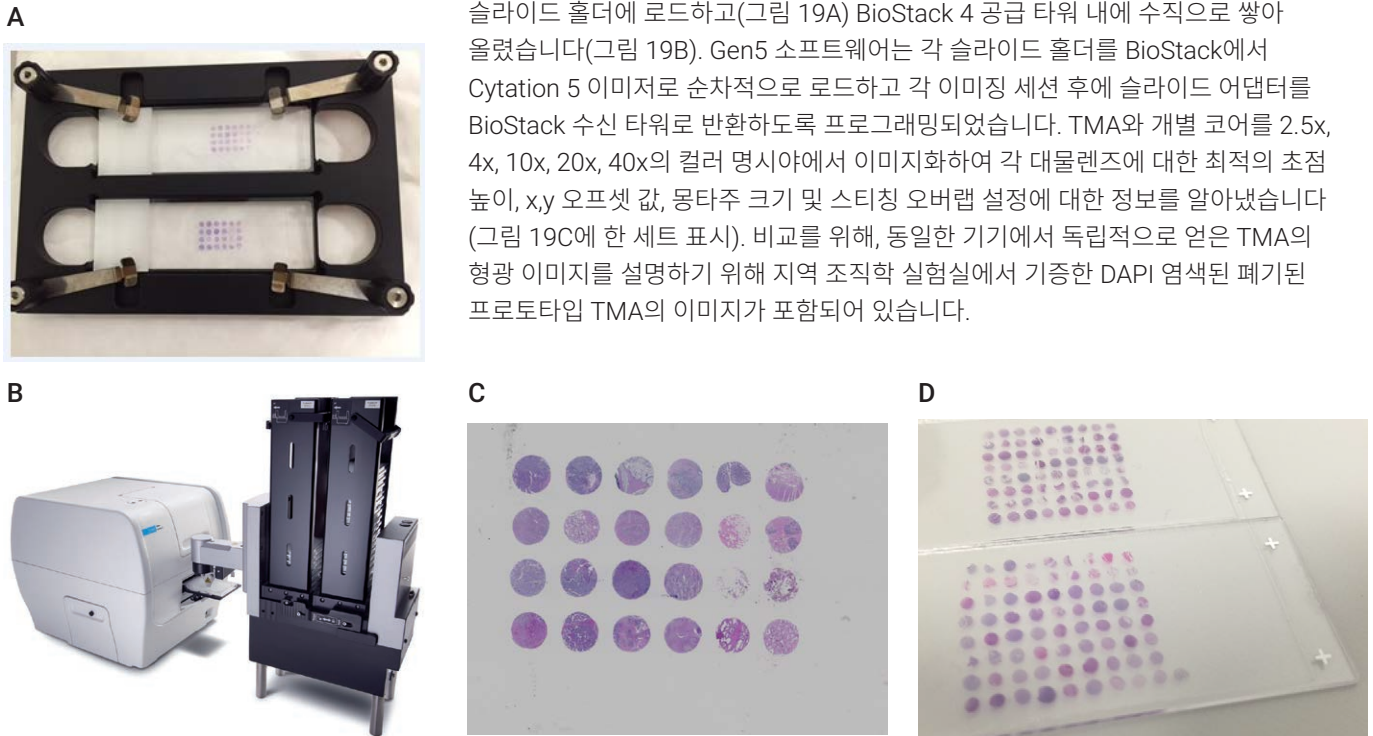
그림 19. 마이크로어레이 슬라이드. (A) 두 개의 TMA 슬라이드는 멀티모드 이미징 리더에 대한 로봇 인터페이스와 호환되는 슬라이드 홀더에 배치됩니다. (B) 소프트웨어는 로봇에서 이미지로 각 슬라이드 홀더를 순차적으로 로드하도록 사전 프로그래밍된 후 자동 몽타주 및 스티칭 기능을 사용하여 각 슬라이드의 15 x 15 이미지를 캡처하여 최종 어레이(C)를 4x로 TMA 중 하나에 표시하도록 했습니다. (D) 두 개의 9 x 8 조직 마이크로어레이(TMA)는 현미경 슬라이드에 서로 다른 오프셋 위치로 표시됩니다. 슬라이드 하단에 있는 마커 코어는 여러 어레이에서 제어 역할을 하며 패널 위치를 식별하는 데 도움이 될 뿐만 아니라 어레이 간의 비대칭 위치 지정에 추가되기도 합니다. Agilent BioTek의 Gen5 소프트웨어에서 사용할 수 있는 맞춤형 x, y 오프셋과 몽타주 및 스티칭 옵션을 사용하여 Agilent BioTek Cytation 5에서 이미징하는 동안 이러한 기하학적 이상 현상을 보정할 수 있으므로 Agilent BioTek BioStack 4 마이크로플레이트 스택을 통해 혼합 크기의 TMA를 더 높은 처리량으로 함께 실행할 수 있습니다.
